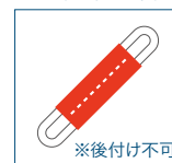
図3 センターシーム2本を束ねて取付け、センターを縫い付ける
