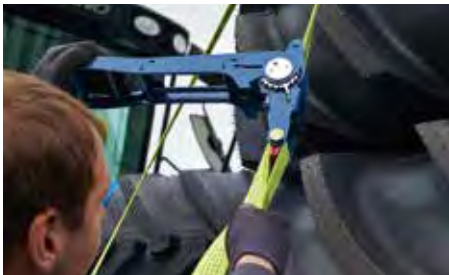
ハイパワーラチェット(締付け力を目視で管理)
