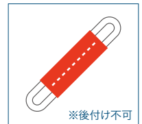
図3-CS センターシーム2本を束ねて取付け、センターを縫い付ける
